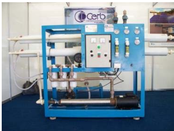
Figura 89- Dessalinizador de água por osmose reversa
