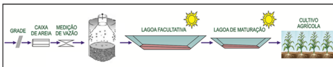
Figura 93 – Fluxograma típico de um sistema de tratamento com reatores UASB seguidos por sistema de lagoas
